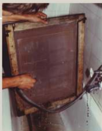
3. Płukanie sita po naświetleniu emulsji
